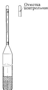
Предназначен для проведения первичной и периодической поверки рабочих ареометров (АОН, АМ, АСП, АК, АС, АМВ).
