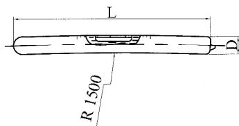
Предназначена для установки в путеизмерительных шаблонах, эксплуатируемых на открытом воздухе.
