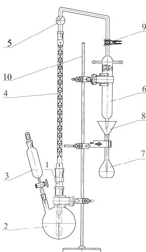
Предназначен для отгонки бензойной кислоты из продуктов переработки плодов и овощей водяным паром для последующего определения содержания бензойной кислоты фотометрическим методом по ГОСТ 28467-90.
