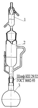
Предназначен для определения водонефтенасыщенности исследуемого грунта, а также водонасыщенности других материалов путем извлечения твердых веществ легкокипящими растворителями.
