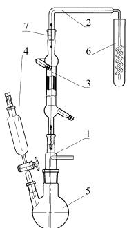
Состоит из насадки поз.1, абсорбера поз.2, холодильника ХПТ поз.3, воронки ВД поз.4, колбы типа КГУ-2 вместимостью 250 мл поз.5, пробирки поз.6. Детали установки соединяются между собой с помощью шлифов конических взаимозаменяемых по ГОСТ 8682-93 и закрепляются пружинками поз.7.
