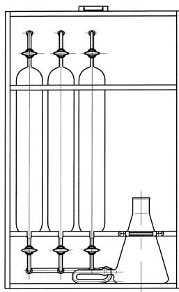
Предназначен для отбора, хранения и транспортирования проб газа.
