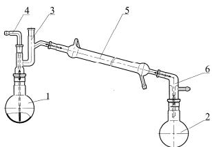
Состоит из колбы реакционной вместимостью 250 или 500 мл поз.1, колбы приемной вместимостью 250 мл поз.2, насадки поз.3, трубы поз.4, холодильника ХПТ поз.5 и алонжа поз.6, соединенных между собой с помощью шлифов конических взаимозаменяемых по ГОСТ 8682-93. Шлифовые соединения закреплены с помощью хомутиков и пружин.
