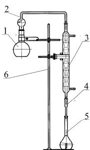
Предназначен для перегонки спирта, применяемого для дальнейшего измерения концентрации этилового спирта в водно-спиртовом растворе по методике ГОСТ 5363-93.
