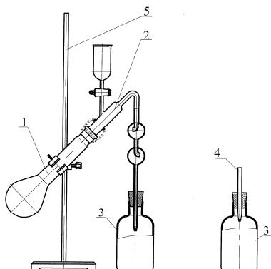
Состоит из колбы Кельдаля поз.1 вместимостью 250 мл, насадки 2 с краном и каплеуловителями, двух склянок 3 с пробками и трубы 4. Стеклянные изделия крепятся на штативе 5
