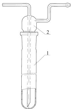
Состоит из пробирки поз.1 и пробки поз.2, соединенных между собой с помощью шлифа конического взаимозаменяемого КШ 24/29 по ГОСТ 8682-93. В прибор входят два таких комплекта.
