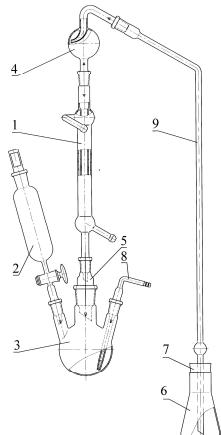
Состоит из холодильника ХПТ-1-200-14/23 поз.1, воронки ВД-2-100, поз.2, колбы КГУ-3-1-250 поз.3 со штуцером поз.8, каплеуловителя КО-14/23-60 поз.4, перехода П-1-29/32-14/23 поз.5, колбы Кн-3-100-34 поз.6, пробки резиновой поз.7, трубы соединительной поз.9
