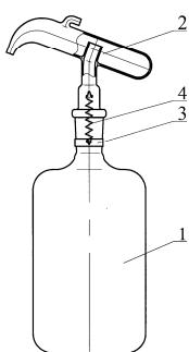
Состоит из склянки вместимостью 500 мл поз.1 и дозатора поз.2, соединенных между собой с помощью шлифа конического взаимозаменяемого КШ 19/26 по ГОСТ 8682-93 и закрепленных хомутиком поз.3 и пружинками поз.4.
