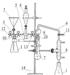
Предназначен для дистилляции амиака с водяным паром и применяется при измерении массовой доли общего азота по Кельдалю и определении массовой доли белка в сыром, пастеризованном и стерилизованном молоке, а также кисломолочных напитках без наполнителей по методике ГОСТ 23327-98.
