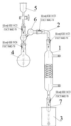
Состоит из холодильника поз.1, изгиба поз.2, стакана поз.3, колбы круглодонной вместимостью 100 мл поз.4, воронки поз.5, каплеуловителя поз.6, барбатера поз.7.
