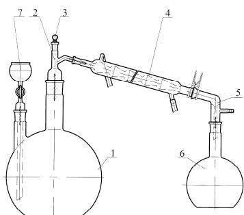
Предназначен для получения дистиллированной воды, а также отдельных фракций различных веществ путем перегонки.
