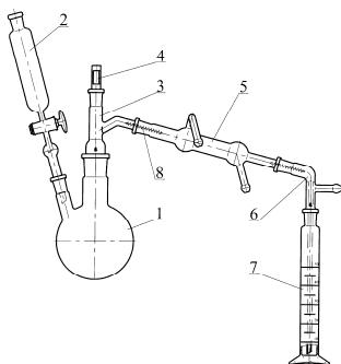
Состоит из колбы испарительной двухгорловой КГУ-2-1-500-29/32 поз.1, воронки капельной ВК-50 поз.2, насадки Н1-29/32-14/23-14/23 поз.3 с пробкой поз.4, холодильника ХПТ-1-100-14/23 поз.5, алонжа типа АИО поз.6 и цилиндра мерного 2-50-2 поз.7. Стеклянные детали соединяются с помощью шлифов конических взаимозаменяемых по ГОСТ 8682-93 и закрепляются пружинками поз.8.
