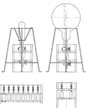
Предназначен для определения содержания кислорода в чистом азоте и аргоне колориметрическим методом. Применяется в химической промышленности.
