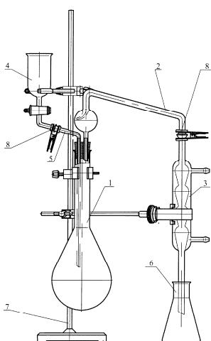
Состоит из колбы Кильдаля вместимостью 1000 мл поз.1, каплеуловителя поз.2, холодильника шарикового поз.3, воронки с краном поз.4, трубы поз.5 и приемной конической колбы вместимостью 250 мл поз.6. Комплект устанавливается на штативе поз.7 с помощью держателей.
