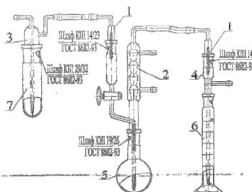
Состоит из керна КИО поз.1, холодильника с воронкой поз.2, пробки поз.3, алонжа поз.4, колбы поз.5, цилиндра мерного 2-25-2 ГОСТ 1770-74 поз.6, пробирки П4-50-29/32 ГОСТ 25336-82 поз.7. Детали установки соединяются между собой с помощью шлифов конических взаимозаменяемых по ГОСТ 8682-93 и закрепляются пружинками поз.8.
