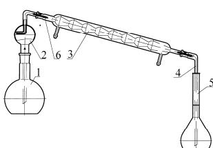
Состоит из колбы испарительной плоскодонной поз.1, насадки Кьельдаля поз.2, холодильника поз.3, алонжа поз.4, приемной колбы мерной поз.5, соединенных шлифами коническими взаимозаменяемыми по ГОСТ 8682-93 и пружинками поз.6.
