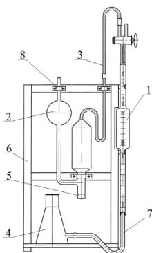
Предназначен для определения процентного содержания кислорода в техническом и медицинском кислороде и кислородсодержащих газовых смесях при контроле производственного кислорода и при технологическом контроле работы воздухоразделительных установок.
