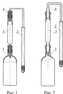
Предназначен для отгонки и поглощения мышьяка в питьевой воде в соответствии с ГОСТ 4152-89.
