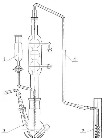
Состоит из холодильника 1, абсорбера 2, колбы со штуцером 3, трубы 4. Детали аппарата соединяются между собой с помощью шлифов конических взаимозаменяемых по ГОСТ 8682-93, закрепленных соответственно пружинками. Габаритные размеры, мм – 300x64x420
