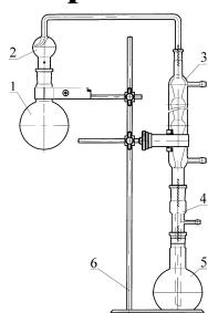
Состоит из колбы испарительной круглодонной поз. 1, насадки с каплеуловителем поз. 2, холодильника шарового поз. 3, переходника с отводом поз. 4, колбы приемной плоскодонной вместимостью 500 мл поз. 5, соединенных между собой с помощью шлифов конических взаимозаменяемых, закрепленных хомутиками и пружинами. Детали прибора устанавливаются в держатели на штативе поз. 6
