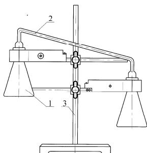
Состоит из двух колб конических вместимостью 100 мл поз.1, соединенных между собой трубкой соединительной поз.2 и закрепленных на штативе с держателями поз.3.
