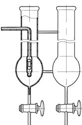
Представляет собой цельнопаянную стеклянную конструкцию с кранами К1Х-1-32-2,5 по ГОСТ 7995-80 и отводом диаметром 7 мм, поплавком диаметром 6 мм и длиной 20 мм.
