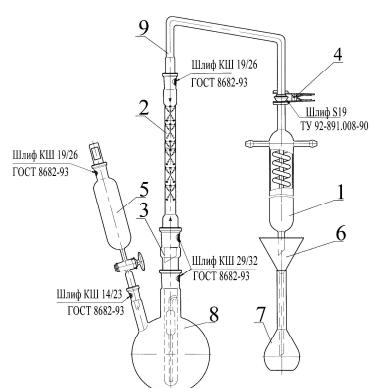
Состоит из холодильника типа ХСВ поз.1, дефлегматора поз.2, сосуда для перегонки поз.3, зажима поз.4, воронки ВД поз.5, воронки поз.6, колбы мерной поз.7, колбы КГУ-2 поз.8, трубки соединительной поз.9.
