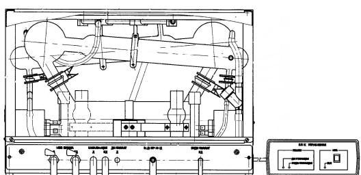
Предназначен для получения дважды дистиллированной воды повышенного качества. Может использоваться также в качестве дистиллятора производительностью около 6,5 л/ч.
