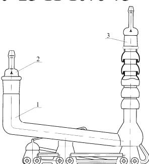
Предназначен для получения в приборах и аппаратах высокого вакуума. Принцип действия насоса основан на создании вакуума за счет эжекции паров масла.
