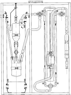
Предназначен для количественного определения содержания незначительных количеств растворенной или частично выделившейся из раствора воды в изоляционных, турбинных и специальных нефтяных маслах.
