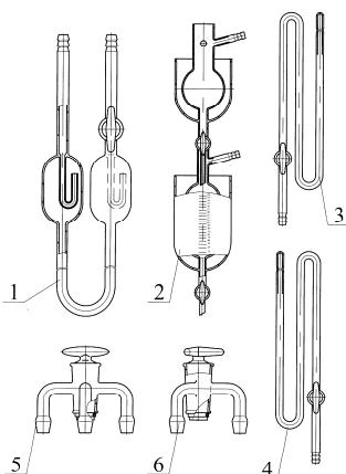
Представляет собой комплект стеклоизделий для прибора определения фракционного состава нефтепродуктов. Включает в себя дифманометр поз.1, приемник поз.2, вакуумметр левый поз.3, вакуумметр правый поз.4, краны трехходовые поз.5 и поз.6.
