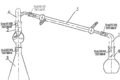
Состоит из изгиба поз.1, каплеуловителя поз.2, колбы конической поз.3, колбы плоскодонной поз.4, холодильника ХПТ поз.5, насадки поз.6
