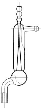
Предназначен для создания предельного остаточного давления при лабораторных работах путем использования давления водопроводной воды.
