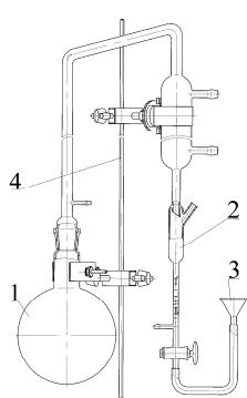
Предназначен для определения содержания эфирного масла в растительном сырье по методу Клевенджера.
