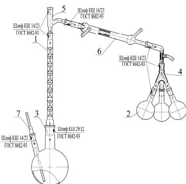
Состоит из дефлэгматора поз.1, колб круглодонных поз.2, колбы двугорлой поз.3, комплекта АКП поз.4, насадки поз.5, холодильника поз.6, трубы поз.7.
