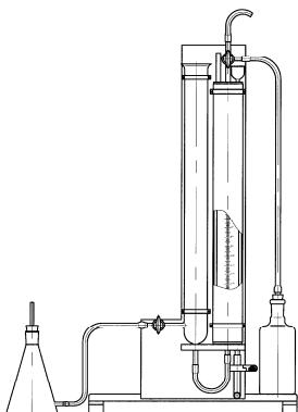
Предназначен для определения процентного содержания углекислоты, связанной с химическим поглотителем, а также для определения содержания кислорода в кислородообразующих веществах.
