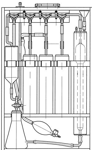
Предназначен для определения объемного содержания суммы всех кислотообразующих газов, кислорода, окиси углерода или непредельных углеводородов в дымовых и газовых смесях по методике ГОСТ 5439-76.
