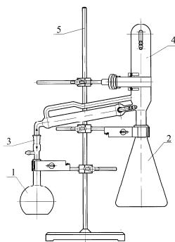
Предназначен для отгонки спиртосодержащих жидкостей при изготовлении спиртоводочных изделий.
