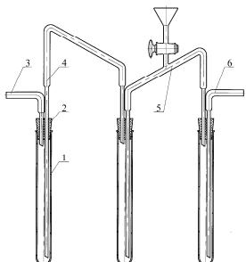
Состоит из трех пробирок П1-22-200 поз.1, закрытых резиновыми пробками поз.2, через которые проходят стеклянные трубы поз.3,4,5,6. Трубка поз.5 имеет стеклянную воронку диаметром 36 мм с краном К1Х-28-1,6 по ГОСТ 7995-80.
