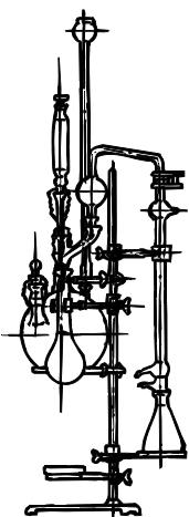
Предназначен для определения азота в органических веществах.
