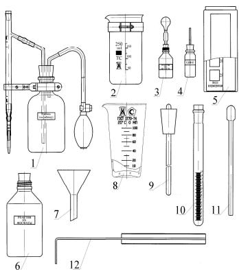
Предназначена для эксплуатационного химического контроля качества конденсата, дистиллята, исходной, питательной и котловой воды паросиловых установок и охлаждающей воды двигателей внутреннего сгорания.
