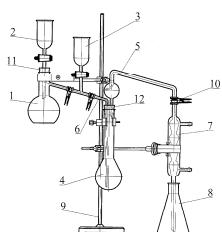
Состоит из колбы испарительной поз.1 вместимостью 500 мл с пробкой резиновой поз.11, воронки с краном поз.2, воронки с краном поз.3, колбы Кельдяля 2-250-20 поз.4 с пробкой резиновой поз.12, каплеуловителя поз.5, трубы поз.6, холодильника шарикового поз.7 и приемной колбы конической вместимостью 500 мл поз.8. Детали аппарата крепятся на штативе поз.9 в держателях и соединяются между собой с помощью шлифов сферических, закрепленных зажимами поз.10.
