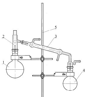
Состоит из испарительной колбы вместимостью 500 мл поз.1, насадки поз.2, холодильника типа ХПТ поз.3, приемной колбы вместимостью 250 мл поз.4, закрепленных на штативе поз.5 с помощью держателей. Стеклянные детали соединяются между собой с помощью шлифов конических взаимозаменяемых по ГОСТ 8682-93 и закрепляются хомутиками и пружинами.
