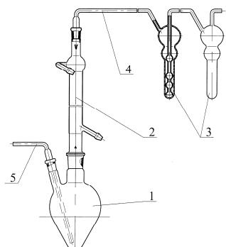
Состоит из колбы остродонной ОГ-2-500-29/32-14/23 поз.1, холодильника ХПТ-2-400-29/32-14/23 поз.2, двух поглотителей Рихтера скоростных поз.3, трубы соединительной поз.4, керна типа КИО поз.5. Детали соединяются между собой шлифами коническими взаимозаменяемыми по ГОСТ 8682-93 и трубкой резиновой медицинской поз.6.
