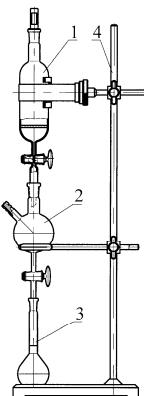
Состоит из воронки делительной фильтрующей поз.1, воронки делительной шарообразной вместимостью 100 мл поз.2 и колбы мерной вместимостью 50 мл поз.3, соединяющихся между собой с помощью шлифов конических взаимозаменяемых по ГОСТ 8682-93. Детали прибора устанавливаются на штативе поз.4 с помощью держателей.
