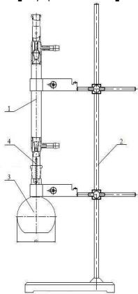
Состоит из холодильника типа ХШ поз.1, колбы испарительной плоскодонной вместимостью 250 мл поз.3, соединенных между собой шлифом коническим взаимозаменяемым КШ 19/26 по ГОСТ 8682-93 и пружинами поз.3, и штатива поз.2.
