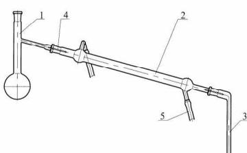
Состоит из колбы с отводом поз.1, холодильника ХПТ поз.2, алонжа поз.3, соединенных между собой с помощью шлифов конических взаимозаменяемых. Шлифовые соединения закреплены пружинками поз.4.
