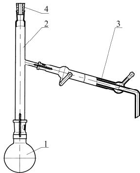
Предназначен для количественного определения спирта в настойках, рассчитываемого по температуре кипения настойки при определенном давлении. Состоит из колбы вместимостью 250 мл поз. 1, насадки поз. 2, холодильника типа ХПТ поз. 3 и пробки резиновой поз. 4. Детали соединены между собой с помощью шлифов конических взаимозаменяемых. Шлифовые соединения закрепляются хомутиками и пружинами.
