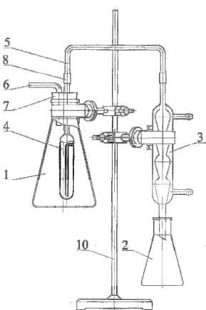
Состоит из испарительной колбы конической вместимостью 1000 мл поз.1, приемной колбы конической вместимостью 250 мл поз.2, холодильника четырехшарового длиной 200 мм поз.3, сосуда поз.4, трубы соединительной поз.5 и трубы изогнутой поз.6, вставленных в пробку поз.7. Детали аппарата соединяются между собой трубками резиновыми поз.8.
