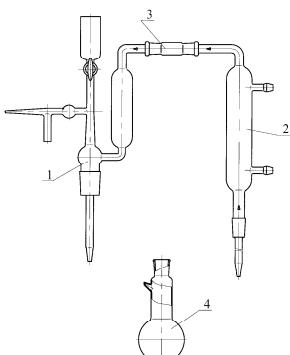
Состоит из воронки с краном поз.1 и холодильника поз.2, соединенных между собой муфтой поз.3, а также колбы приемной специальной вместимостью 100 мл поз.4.
