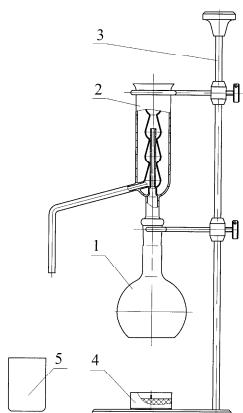
Предназначен для получения небольших количеств дистиллированной воды в домашних условиях.
