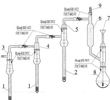
Состоит из сосудов поз.1 и поз.2, насадок поз.3, поз.4, поз.5, холодильника поз.6, насадки с воронкой поз.7, колбы грушевидной вместимостью 250 мл поз.8, пробки стеклянной поз.9.
