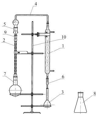
Состоит из холодильника поз.1, дефлэгматора поз.2, колбы мерной поз.3, насадки поз.4, перехода поз.5, трубы поз.6, колбы конической, вместимостью 500 мл поз.7, колбы конической, вместимостью 250 мл (сменная часть) поз.8. Детали установки соединяются между собой с помощью шлифов конических взаимозаменяемых по ГОСТ 8682-93, закрепляются пружинками поз.9 и устанавливаются на штативе поз.10 с помощью держателей.
