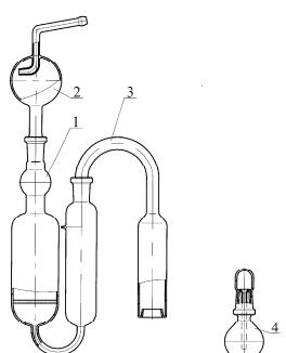
Предназначен для определения содержания серы в нефтепродуктах сжиганием в лампе по ГОСТ 19121. Допускается использование прибора для определения содержания других элементов в нефтепродуктах.
