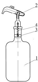
Предназначен для отмеривания изоамилового спирта при определении содержания жира в молоке и молочных продуктах по ГОСТ 5867.
