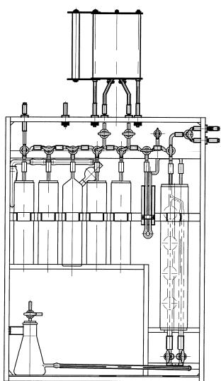
Предназначен для общего анализа природных и промышленных газов с целью определения объемного содержания кислорода, окиси углерода, суммы кислотообразующих газов, водорода, непредельных углеводородов, азота и инертных газов в дымовых и газовых смесях по методике ГОСТ 5439-76.
