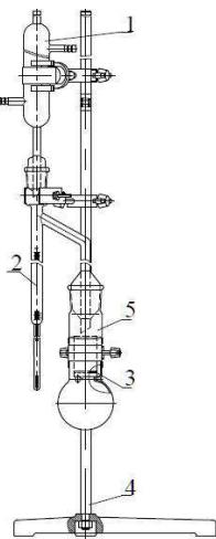
Предназначен для определения водонасыщенности исследуемого грунта, а также других материалов путем извлечения твердых веществ легкокипящими растворителями.
