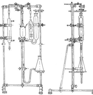
Предназначен для объемного определения газовых смесей СО и CO<sub>2</sub>, получаемых при анализе чугуна и сталей методом сжигания навески по ГОСТ 12344-88 и утвержденным методикам с дальнейшим расчетом содержания углерода в %.
