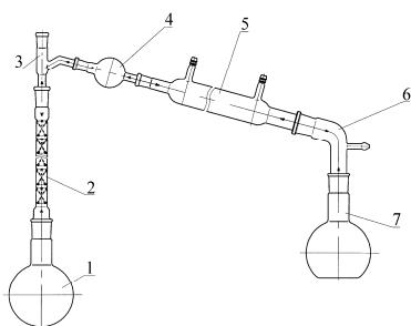
Состоит из колбы испарительной К-1-500-29/32 поз. 1, дефлэгматора 300-19/26-29/32 поз. 2, насадки Н1-19/26-14/23-14/23 поз. 3, каплеуловителя КП-14/23 поз. 4, холодильника ХШ-1-400-29/32 поз. 5, алонжа АИО-29/32-29/32-75 поз. 6 и колбы приемной П-1-500-29/32 поз. 7. Детали соединяются между собой шлифами коническими взаимозаменяемыми по ГОСТ 8682-93.
