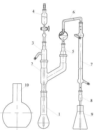
Состоит из колбы Кильдаля вместимостью 250 мл поз.1, насадки Н3-29/32 поз.2, насадки поз.3, воронки капельной вместимостью 100 мл поз.4, перехода П1-1-29/32-14/23 поз.5, каплеуловителя КО-14/23-100 поз.6, холодильника ХПТ-1-300-14/23 поз.7, трубы поз.8, колбы конической вместимостью 250 мл поз.9, колбы плоскодонной вместимостью 2000 мл. поз.10
