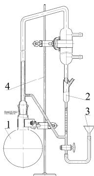
Предназначен для определения содержания эфирного масла в растительном сырье по методу Клевенджера.
