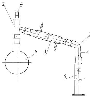
Состоит из холодильника Либиха длиной 300 мм поз. 1, насадки типа Н1-29/32-29/32-29/32 поз. 2, алонжа АИО-29/32-29/32-75 поз. 3, перехода П1-29/32-14/23 поз. 4, цилиндра мерного 2-250-2 поз. 5, колбы круглодонной К-1-1000-29/32 поз. 6
