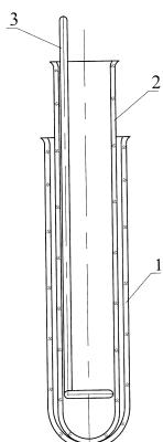
Состоит из внешней пробирки поз.1, внутренней пробирки поз.2 и мешалки поз.3.
