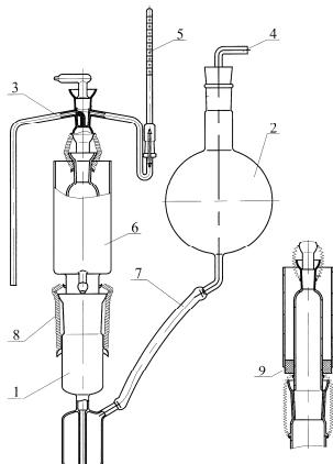
Состоит из приемника поз.1, колбы с пробкой поз.2, крана поз.3, отвода поз.4, трубки градуированной с шлифом поз.5, камеры с расширителем поз.6, резиновой трубы поз.7. Детали прибора соединяются друг с другом с помощью шлифов конических взаимозаменяемых и стягиваются пружинками поз.8
