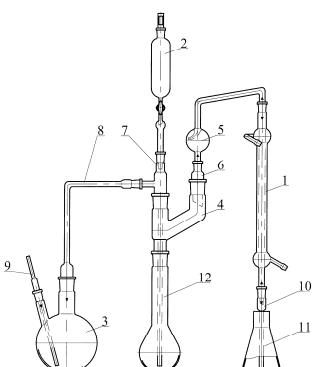
Состоит из холодильника ХПТ-1-300-14/23 поз.1, воронки капельной ВК-100 поз.2, колбы КГУ-2-1-1000-29/32 поз.3, насадки НЗ-29/32 поз.4, каплеуловителя КО-14/23-100 поз.5, перехода П1-29/32-14/23 поз.6, насадки специальной поз.7, изгиба поз.8, трубы поз.9, трубы поз.10, колбы конической Кн-3-250-34 поз.11, колбы Кельдаля 1-250-29/32 поз.12. В качестве сменных частей поставляются колба Кельдаля 1-500-29/32 и колба коническая Кн-3-500-34.
