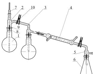
Состоит из двух круглодонных колб вместимостью 500 мл поз. 1, насадки поз. 2, насадки-барбатера поз. 3, холодильника поз.4, алонжа поз. 5, колбы конической вместимостью 250 мл поз. 6 и трубы поз. 7, соединенных между собой шлифами коническими взаимозаменяемыми, закрепленными с помощью хомутиков поз. 8 и пружин поз. 9, и шлифтами сферическими, закрепленными зажимами поз. 10.
