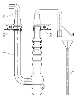
Предназначен для получения в приборах и аппаратах высокого вакуума. Состоит из корпуса поз. 1, зажима поз. 2, переходников поз. 3 и поз. 4, воронки поз. 5
