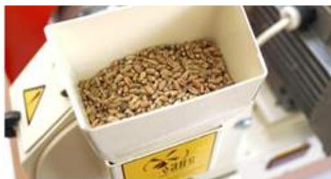
Лабораторный шелушитель применяется в научно-исследовательских лабораториях, на зернопроизводящих, хлебоприемных и перерабатывающих предприятиях для исследования процессов шелушения зерна.
