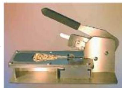
Резак для зерна Рнеумас был специально разработан для надежного и точного разделения зерен ячменя или пшеницы для дальнейшего использования полученного зернового продукта в тестах на жизнеспособность.
