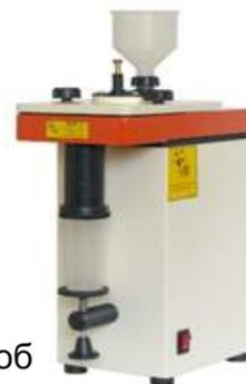
для определения количества и качества клейковины, «числа падения», содержания белка, а также других показателей, при определении которых требуется размол продукта по заданной крупности. Мельница обеспечивает размол навески зерна массой от 10г до 100г с заданным стабильным размером частиц. Ситовой контроль измельченного продукта не требуется (сход сита N 067 не более 1%, проход сита N 38 не менее 60%). Мельница оснащена сменными калиброванными ситами диаметром 0,8 и 1,0 мм.
