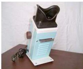
Прибор состоит из корпуса, кассеты на 100 зерен; механизма перемещения кассеты, позволяющего одновременно просматривать 10 зерен; источника света (лампы накаливания напряжением 220 В, мощностью 30 Вт), линзы с увеличением 1,43. На решетку кассеты высыпает навеску зерна массой 50–70 г и, покачивая, заполняют гнезда решетки зернами. Анализируемые зерна располагаются на решетке в 10 рядов по 10 зерен в каждом.
