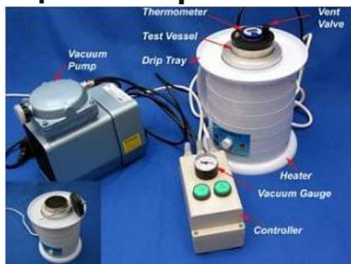
Предельная экономичность и эффективность нагревательного модуля мощностью 350 Вт (примерно 200 Вт при работе от сети 110 В переменного тока).
