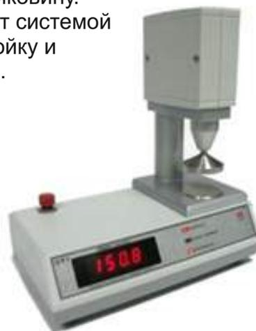
Прибор ИДК-3М утвержден для методов определения количества и качества клейковины (ГОСТ 13586.1, ГОСТ 27839) и внесен в Государственный реестр средств измерения.
