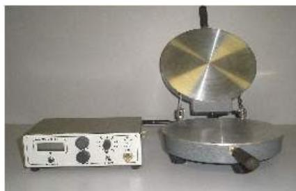
Прибор предназначен для работы в невзрывоопасных помещениях лабораторий пищевых предприятий при температуре окружающего воздуха от +5 до +40°C и относительной влажности 80% при 35°C.
