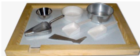
Шпатель зерновой металлический предназначен для разбора образцов зерна, отделения примесей и т.д. Имеет две скошенные стороны разной ширины. Совочки лабораторные предназначены для отбора проб и необходимы в большинстве анализов проводимых по ГОСТ, при определении качества и состояния муки, крупы и зерна.
